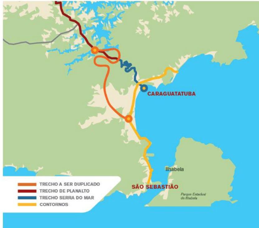
Figura 1 - Croqui esquemático das intervenções previstas na Concessão da Rodovia dos Tamoios. Fonte (adaptado de https://www.concessionariatamoios.com.br/a-rodovia/a-rodovia , acesso em 02/05/2022)
