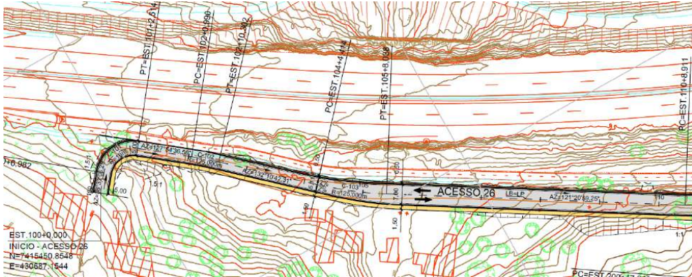
Figura 83: Acesso 26 - Rampa de Transição 28,26% para 7%.
