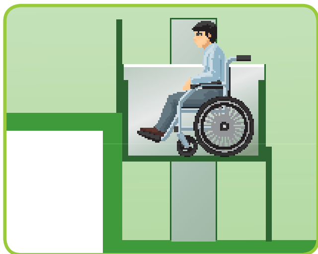
Plataforma vertical: desnível de até 2 m
