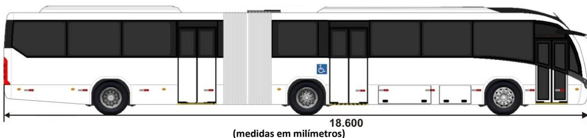
**Figura 3 — Comprimento total máximo Ônibus M3 Articulado**
