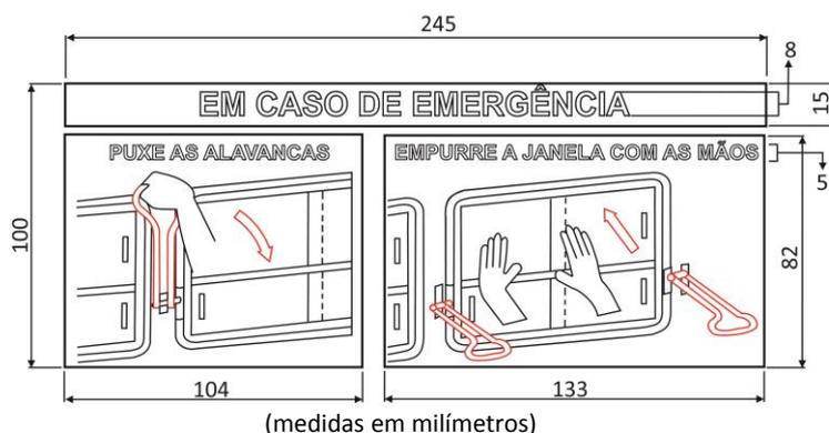
**Figura 8 — Modelo da informação sobre o acionamento da janela de emergência**
