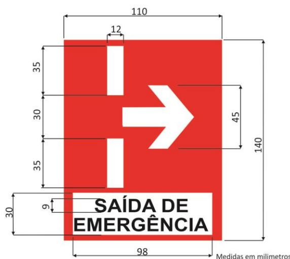
**Figura 7 — Modelo da informação indicativa da saída de emergência**
