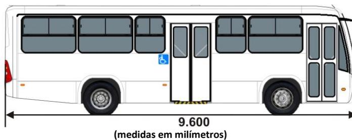
Figura 5 — Comprimento total máximo Miniônibus M3
