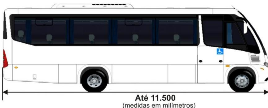
**Figura 2 — Comprimento do Midiônibus M3**
