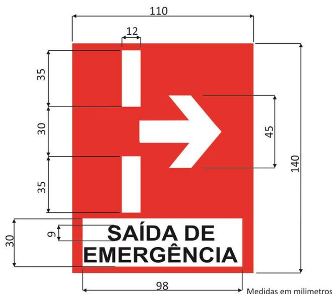
**Figura 6 — Modelo da informação indicativa da saída de emergência**
