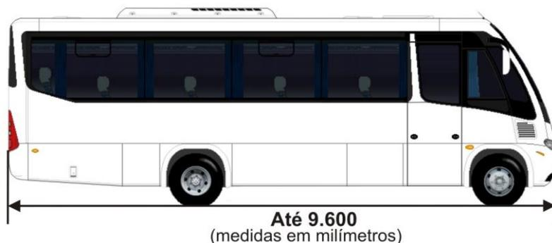
**Figura 3 — Comprimento do Miniônibus M3**
