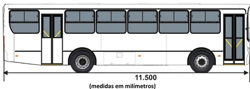
**Figura 4 — Comprimento total máximo Midiônibus M3**
