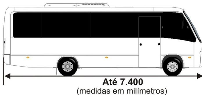
**Figura 4 — Comprimento do Micro-ônibus M3**
