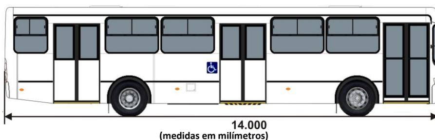
**Figura 1 — Comprimento total máximo Ônibus M3 Básico**
