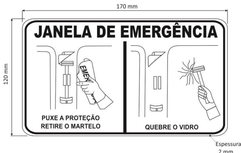
Figura 9 — Modelo da informação com instruções de utilização do dispositivo de destruição
