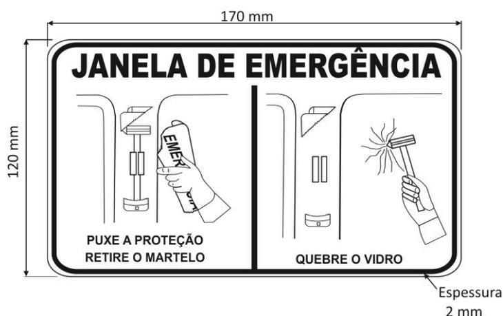
Figura 8 — Modelo da informação com instruções de utilização do dispositivo de destruição
